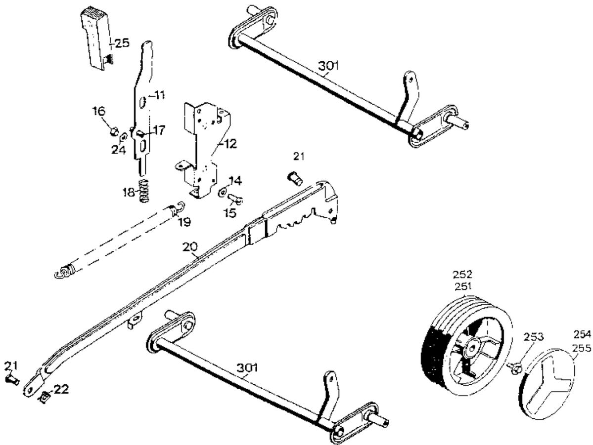
**Gerät: 4.42 B (Achse, Räder & Höhenverstellung)**
