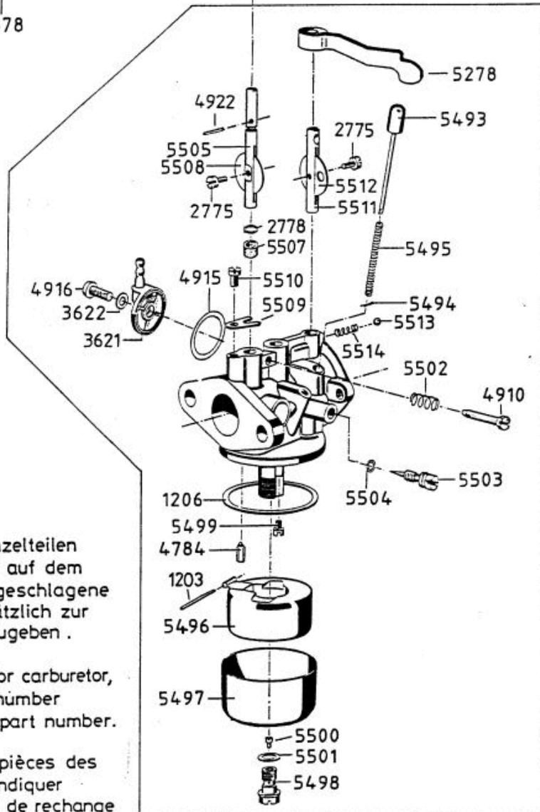
Bei Bestellung von Einzelteilen des Vergasers, ist die auf dem Vergasergehäuse eingeschlagene Vergasernummer zusätzlich zur Ersatzteilnummer anzugeben.
