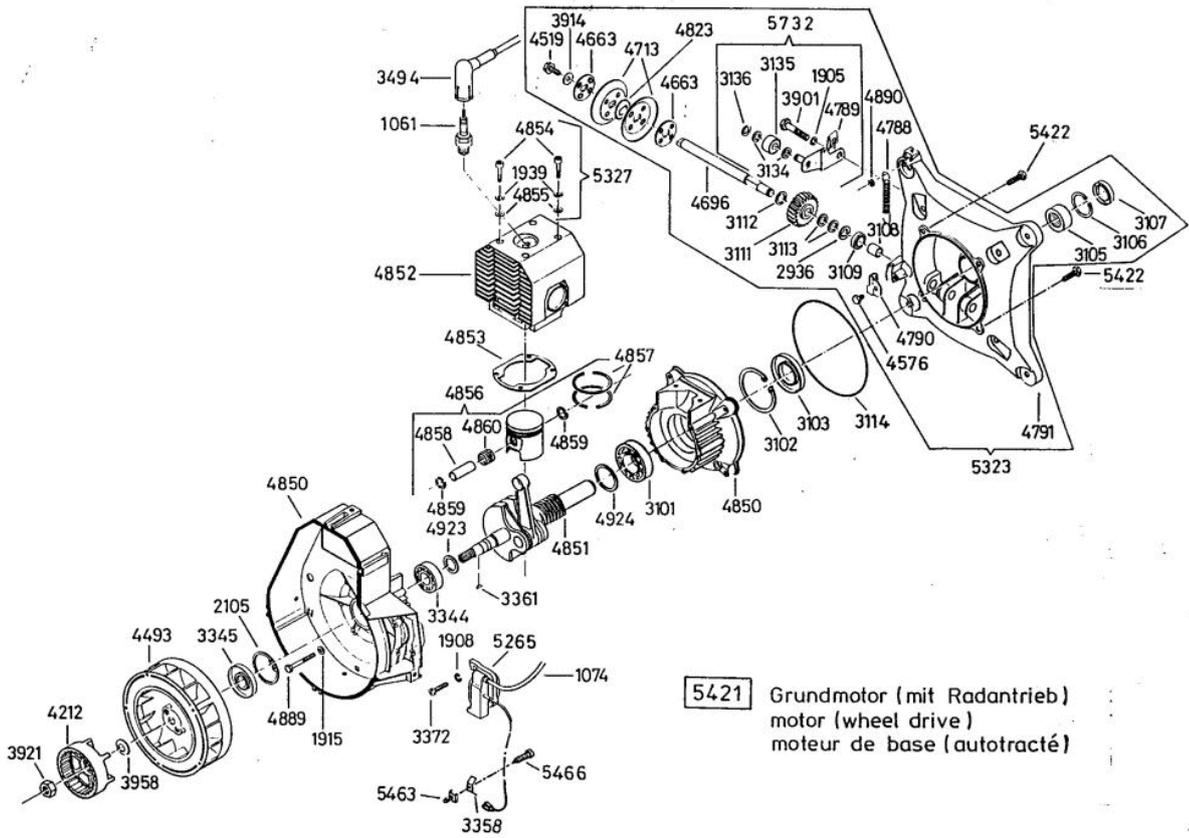
**5421** Grundmotor (mit Radantrieb)
